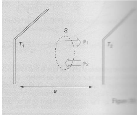
Deux plans métalliques parallèles sont assimilés à des corps noirs de températures respectives  $T_1$  et  $T_2$  uniformes. L'espace les séparant, d'épaisseur  $e$  est vide (Fig. 10).
