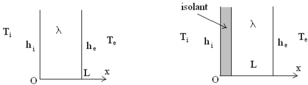
On considère un mur extérieur (surface  $S$ ) d'une maison. Ce mur d'épaisseur  $L = 40$  cm est en pierre de conductivité thermique  $\lambda = 2,0 \text{ W.m}^{-1}.\text{K}^{-1}$
