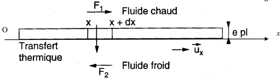
Ce transfert s'effectue à travers une plaque conductrice (voir Fig.). La plaque a une épaisseur  $e$ , une largeur  $L$  (perpendiculairement au plan de la figure) et une aire de contact  $S$  sur chaque face. Le matériau constituant la plaque a une conductivité thermique  $\lambda$  qu'on supposera constante.
