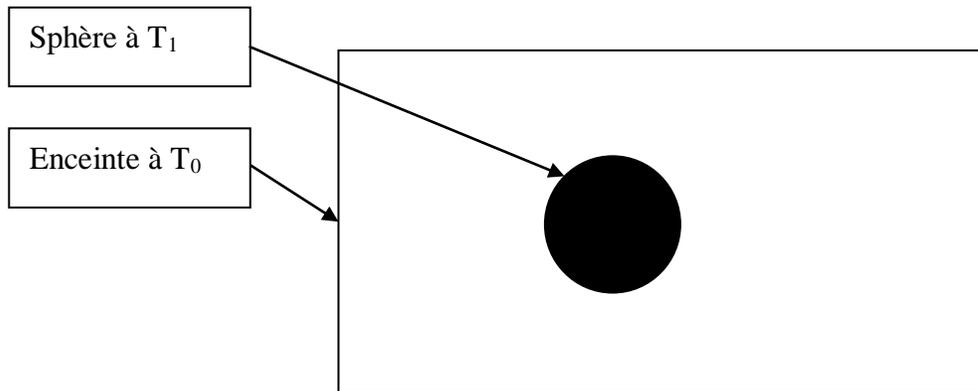
Un corps sphérique de rayon  $a$  de capacité thermique  $C_0$  et de température  $T_1$  est placé dans une enceinte vide de température  $T_0$ . On suppose que le corps sphérique rayonne comme un corps noir et que les autres transferts thermiques peuvent être négligés. On suppose que les températures  $T_0$  et  $T_1$  sont voisines et on peut donc poser :  $T_1 = T_0 + \theta_1$  avec  $\theta_1 \ll T_0$ . On donne :  $T_0 = 273$  K et  $T_1 = 280$  K
