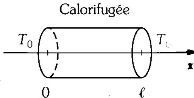
Une tige de longueur  $l$ , de section  $S$  est calorifugée latéralement (Voir Fig.). On note  $D$  le coefficient de diffusion,  $\lambda$  étant la conductivité thermique,  $\rho$  la masse volumique et  $c$  la capacité thermique massique de la barre.
