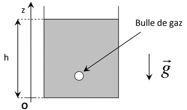
Dès que l'un d'entre elle décolle du fond du récipient, le cafetier actionne un chronomètre pour mesurer l'intervalle de temps nécessaire à la bulle pour que celle-ci atteigne la surface libre (voir schéma). Il obtient une mesure correspondant à une durée  $t_0$  de 1,2 s.
