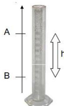
1. A l'aide du matériel présent, établir un protocole expérimental permettant d'établir une relation entre la différence de pression  $P_B - P_A$  et la dénivellation  $h$  entre ces deux points.
