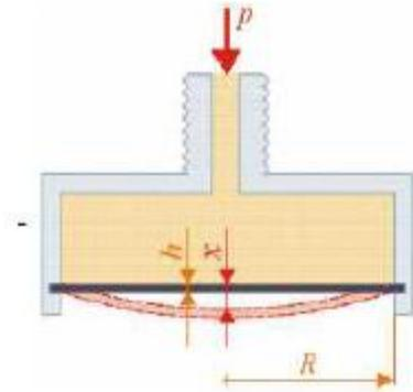
La membrane est tendue entre deux brides. Par un trou dans le raccord, le fluide à mesurer arrive dans la chambre de pression en dessous de la membrane. La membrane se déplace sous l'effet de la pression. Le déplacement de la membrane est proportionnel à la pression mesurée et est transmis par l'intermédiaire du mouvement à l'aiguille et affiché sur le cadran en tant que valeur de pression.
